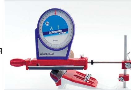
$$\text{требуемый угол заточки} = \frac{\text{угол наклона основания } 20^\circ}{\text{угол по угломеру}} + \text{или} -$$
