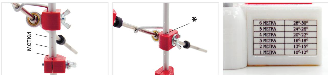
Переместите шаровой шарнир вдоль стойки шарнира до метки соответствующей желаемому углу заточки. Метка угла должна располагаться по верхней части корпуса шарнира\*. Затяните фиксирующий барашек.
