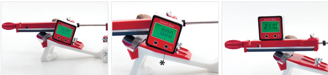
Включите угломер. Установите его на ровную поверхность упора и нажмите кнопку «zero»\*, тем самым Вы задаете угломеру значение «0». Установите угломер на держатель бруска. Угломер покажет половину от общего угла заточки.
