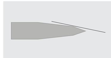
Если маркер стирается по самой нижней кромке подвода – опустите корпус шарового шарнира и попробуйте еще раз.
